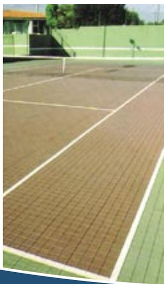
La instalación se realiza in situ sobre la base asfáltica de hormigón, siendo el acabado sin juntas, dado que los productos son resinas sintéticas antideslizantes e impermeables.
